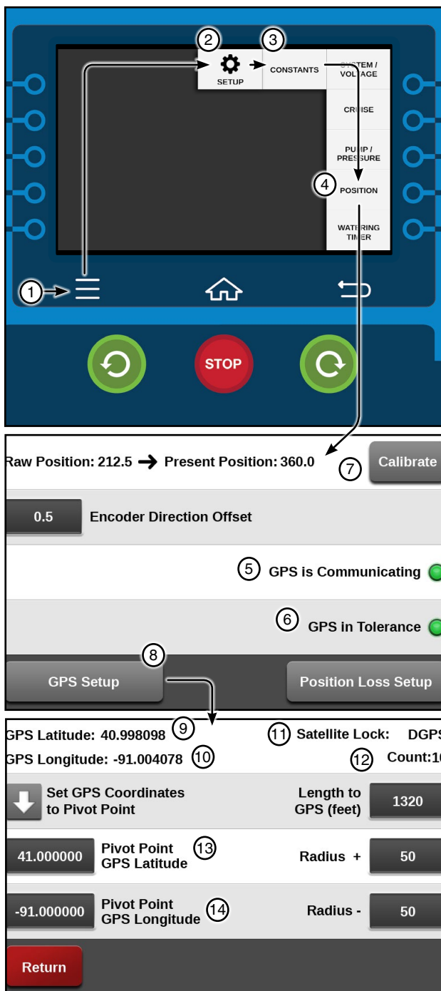
Figure 48-1 1. Menu 9. GPS Latitude' 2. Setup 10. GPS Longitude 3. Constants 11. Satellite Lock 4. Position 12. Count 5. GPS is Communicating 13. Pivot Point Latitude 6. GPS in Tolerance 14. Pivot Point Longitude 7. Calibrate Button 8. GPS Setup
