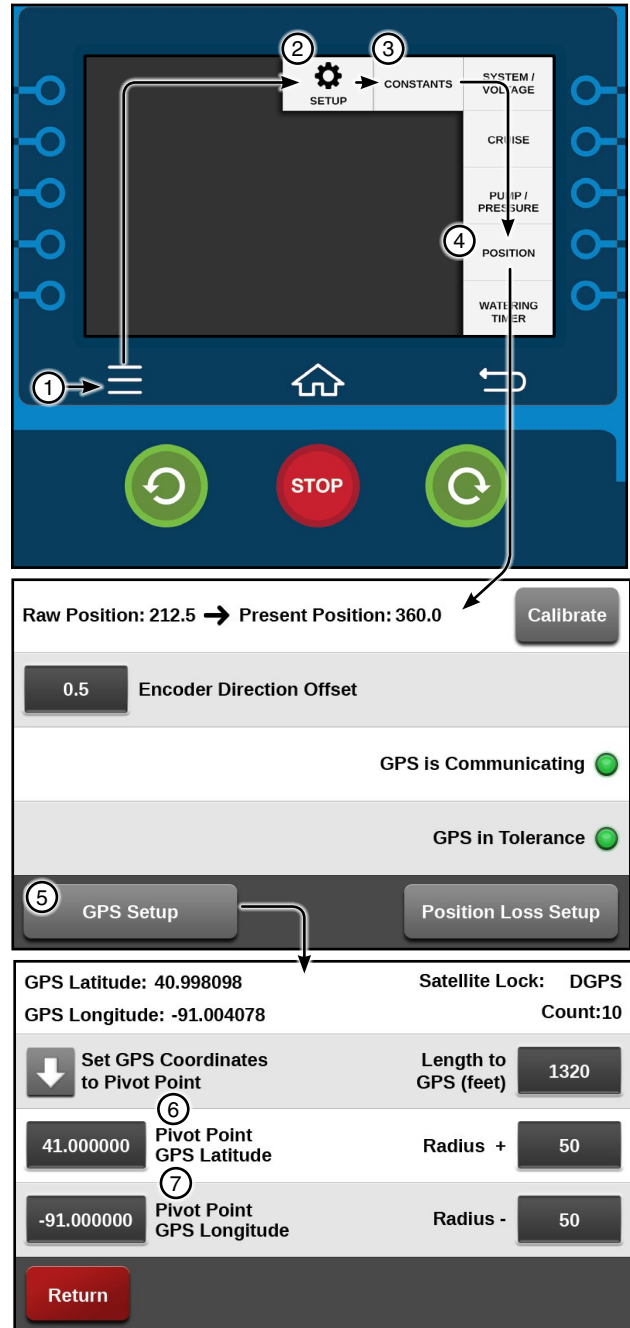
Figure 45-1 1. Menu 5. GPS Setup 2. Setup 6. Pivot Point GPS Latitude 3. Constants 7. Pivot Point GPS Longitude 4. Position
