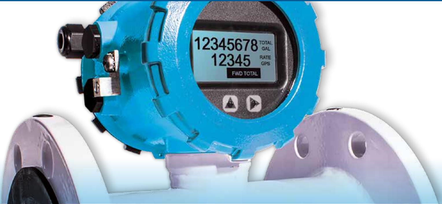
Valley® 3000 是一种阀芯式电磁流量计，适用于 4” 至 12” 管道的灌溉应用。由于不含运动部件，Valley 3000 丝毫不会阻碍水流，并可提供超强的抗磨损能力，从而防止地下水或地表水杂质造成的磨损。
